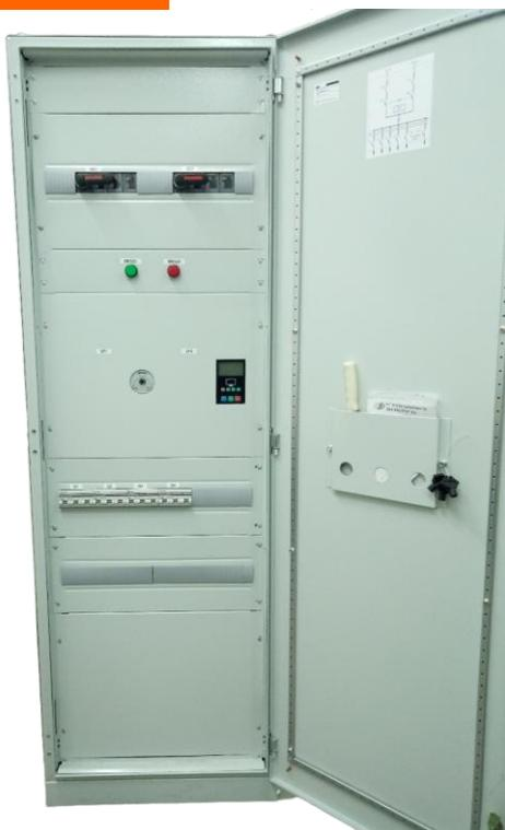
Вводно-распределительные устройства серии ВРУ-21L предназначены для приема, учета и распределения электрической энергии напряжением 400/230В трехфазного переменного тока частотой 50Гц в четырех- и пятипроводных электрических сетях с системами заземления TN-S, TN-C, TN-C-S, и обеспечивают защиту отходящих линий при перегрузках и коротких замыканиях, а также для нечастых оперативных включений и отключений.
